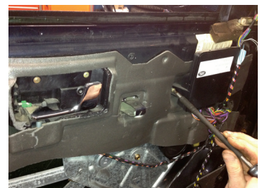
Fig 8 - Unscrew door amplifier.
