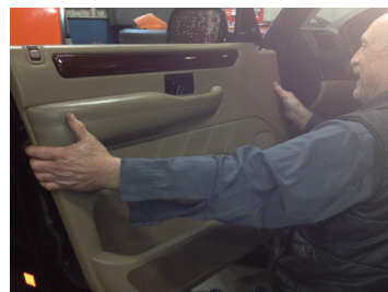
Fig 6 - Remove door panel.
